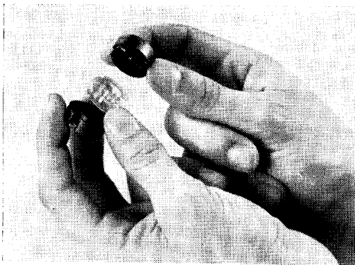
Hier ziet u de beide kernhelften van een P-potkern met het spoel-kokertje
